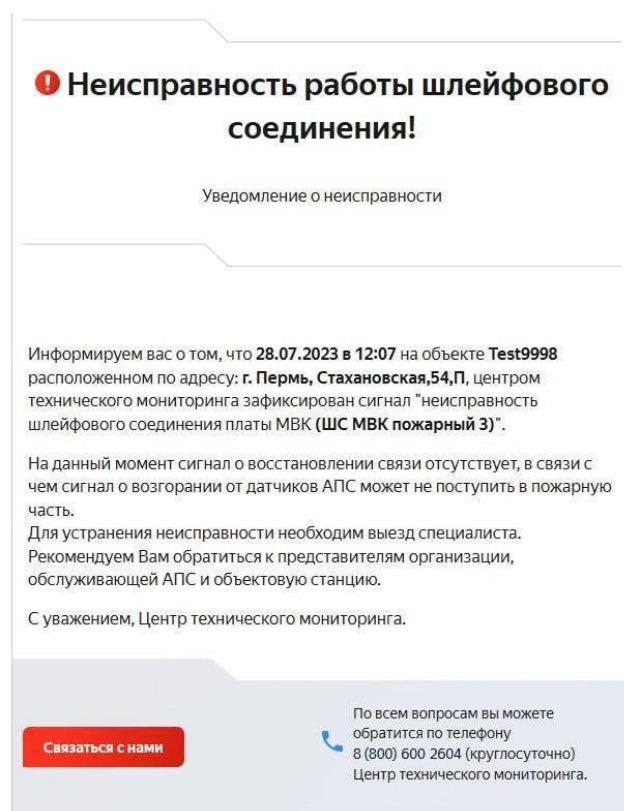
Рисунок 1.1 – Пример уведомления о неисправности работы шлейфового
